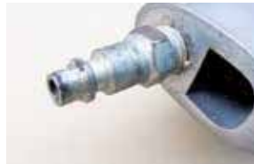
DETALLE DE CONEXIONES NEUMÁTICAS DE ACOPLÉ RÁPIDO Y MARTILLO NEUMÁTICO
