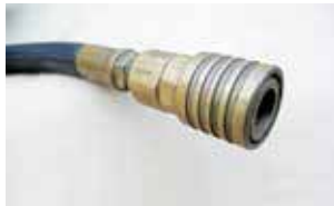
DETALLE DE CONEXIONES NEUMÁTICAS DE ACOPLÉ RÁPIDO Y MARTILLO NEUMÁTICO
