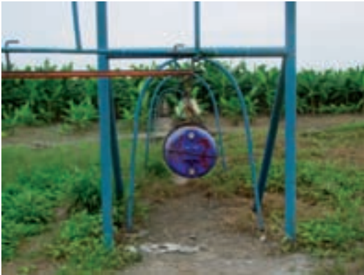
Foto 1: Cableguía utilizado para trasportar los racimos de plátano cosechados hasta los lugares de empacado.
