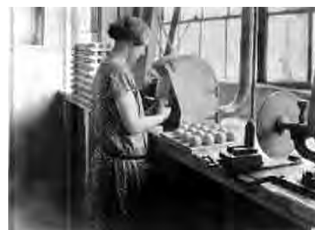
Se desenmolda y se pulen las bolas de billar resultantes del proceso.
