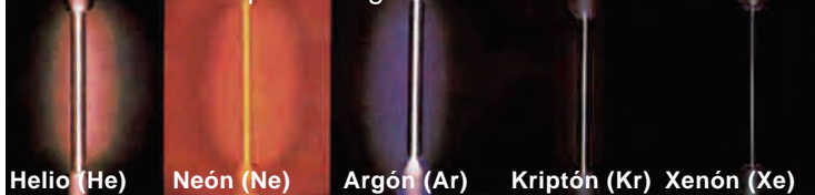
Tubos lumínicos que usan gases nobles
